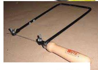
Sierra: Marco de metal que sujeta una sierra o segueta metálica. Usada para el aserrado de metal
